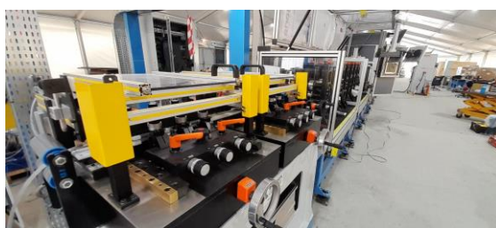
Obr. 1: Prototyp výrobní linky – kontinuální výrobní stroj * Zásobník a příprava pásového materiálu – horní obrázek * Válcovací stolice, svařování a dělení – dolní obrázek
